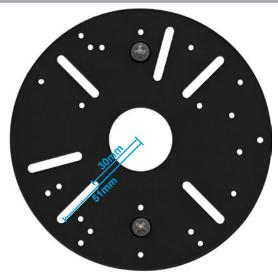
Insgesamt sechs M4-Gewinde können in ihren Schiebevorrichtungen in flexibel eingestellt werden. So eignet sich die Montage von Kameras mit 3 Schrauben im 120 Grad Winkel und auch mit 4 Schrauben im 90 Grad Winkel
